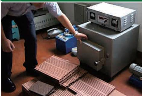
Eee-Woodは、生産ロット毎に検査をします。安定した品質を保つ為に行っております。写真は、風化検査を行う装置です。
