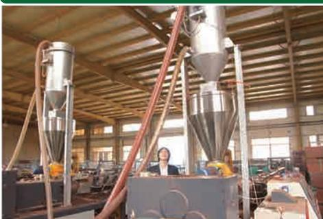
原料を高温で圧縮加工します。気泡の混入を無くし均一で高品質な製品ができる秘訣です。
